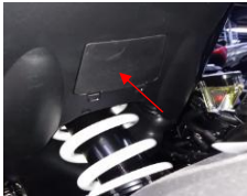
Fig. 4 – Ubicación del controlador
